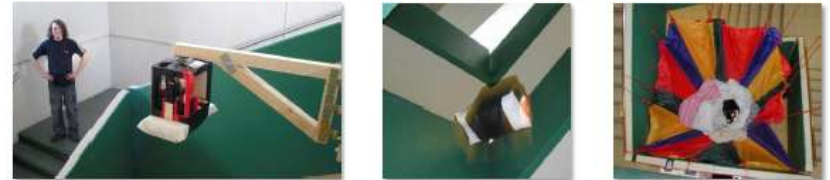
Die Getränkebox ist mit einem Fallexperiment bestückt! Nach rund 2 Sekunden freien Falls in Schwerelosigkeit erfolgt die weiche Landung.
