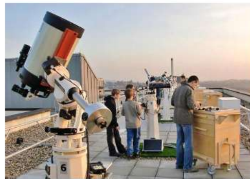
Insel 6 und Insel 1 mit Astro-Physics AP900-Montierung und Celestron 11 EdgeHD-Teleskopen, Teleskopsteuerung per Notebook.
