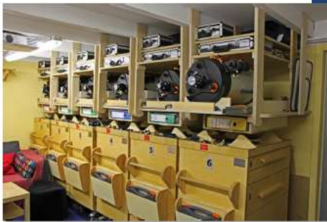
Zu jeder Beobachtungsinsel gehört einer der sechs identisch ausgestatteten Zubehörwagen. Fernsteuerung der Teleskope per Remote Control
